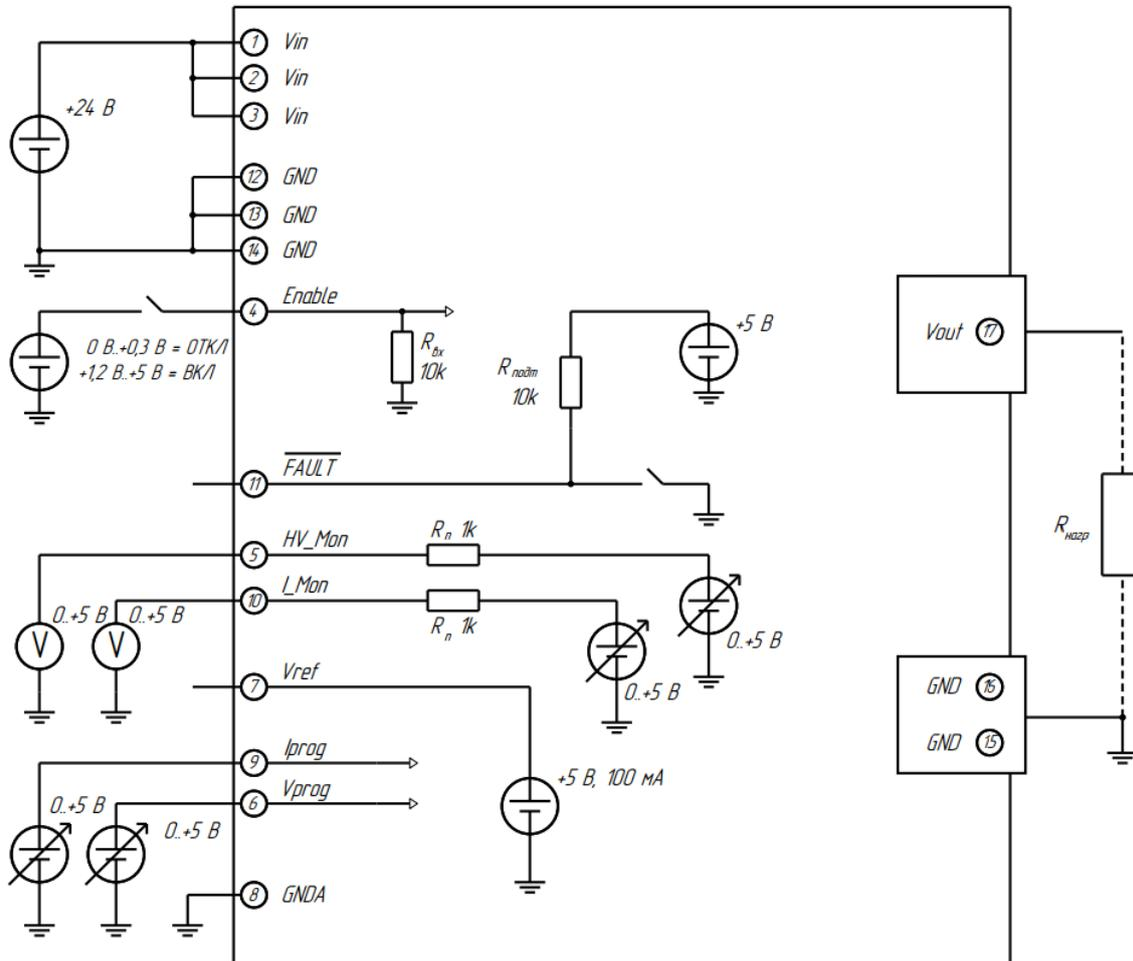
Рис.2 – Схема подключения
